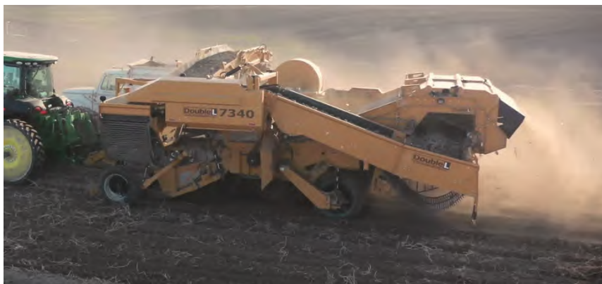
图1 Double L 7340型马铃薯收获机 [16]
