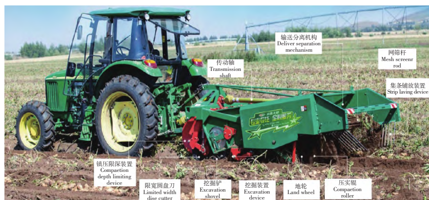
图8 “希森天成”4UX-170A+型马铃薯收获机 [28]
