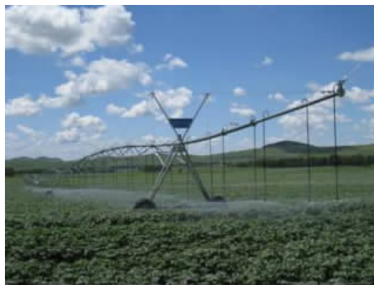
图1 中心支轴式喷灌机
